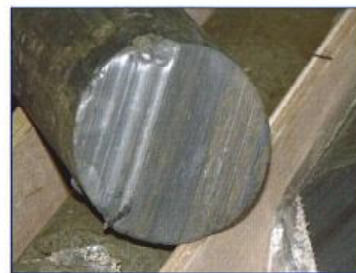
▲主動部のすべり面状況：条線状擦痕の鏡肌面 (BV-10孔・深度13.35m)
