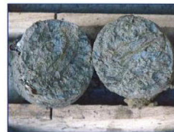
▲受動部のすべり面状況：有機物混じり攪乱粘土 (BV-14孔・深度8.80m)
